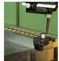
Beim Positionieren der Arbeitsspindelachse an der Werkzeugkante
